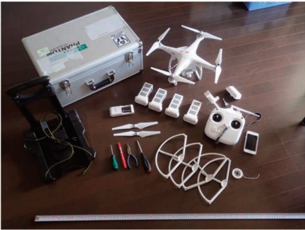
図4 調達した機材一式。Phantom 本体、送信機、リポバッテリー、プロペラガード、予備プロペラはすべてケースに収納可能である。
