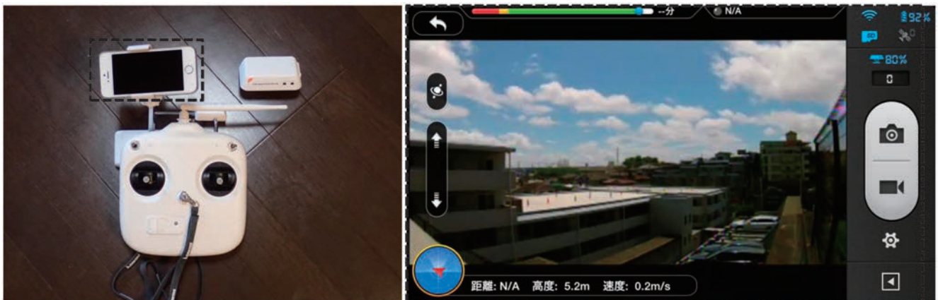
図 8 iPhone6 を端末に利用した FPV システム（左：送信機，iPhone，FPV 伝送装置）およびモニター（右）。
