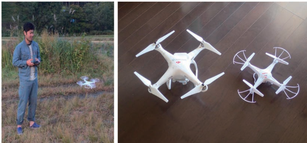
図 6 練習機を利用したホバリングの練習風景 (左) および Phantom と練習機 (右)。向かって左が DJI Phantom Vision2+, 右が練習機である SYMA X50C Explorers。
