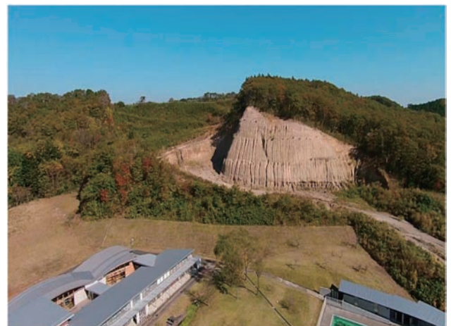
図10 試験運用時の静止画。正面に見える火山灰層の露頭を対象として撮影。操縦者からの距離は水平距離300m、地対高度はおおよそ100m。
