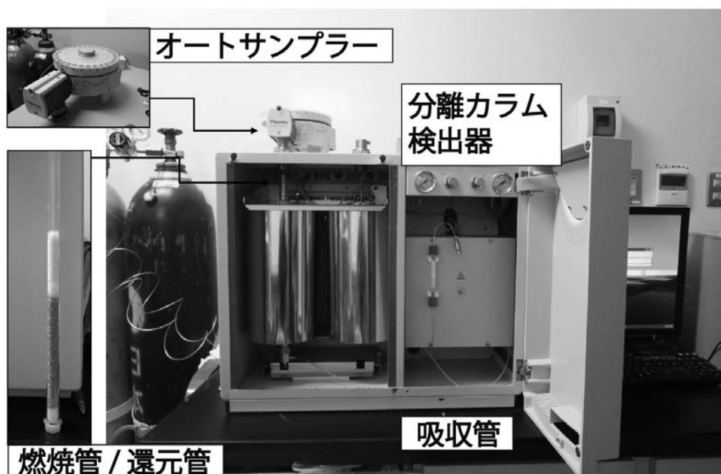
図2 島根大学汽水域研究センターが所有する CNS 分析装置, Flash EA 1112 の付属機器および内部機器。
