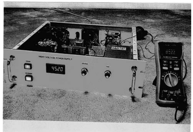
図13 マルチメータとHVプローブを使用してデジタルパネルメータの高電圧表示を校正しているところ。
