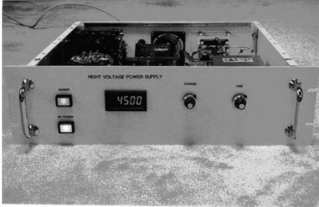
図8 使用部品全部を取り付けて配線完了後のフロントパネル。
