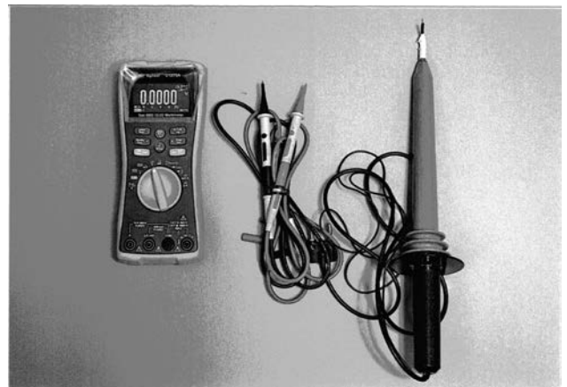
図12 調整に使用したマルチメータ（Agilent U1273A型）と40kV HVプローブ。
