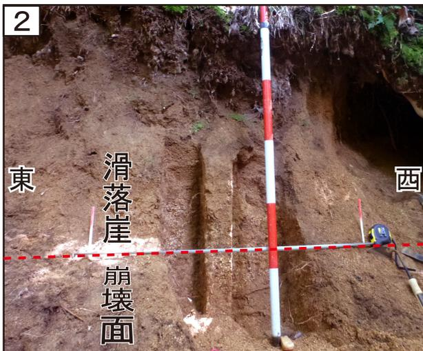
図2 滑落崖での表土層試料採取(試料成形途中). 東西方向の赤破線は滑落崖と崩壊面の境界を示す. 試料は崩壊面の延長部を包含するように採取した。
